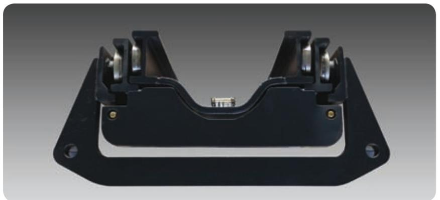
Les performances incomparables du mât Clark sont le fruit de sa structure solide et unique. Ses galets inclinés et étanches réduisent le flambage et les jeux du mât et du tablier. Les six galets du tablier répartissent le poids du chargement de manière uniforme et améliorent ainsi nettement la longévité des galets. Les galets latéraux permettent un parfait coulisement même avec des charges décentrées, et les lames en acier haute résistance prolongent la vie des rails et des galets.
