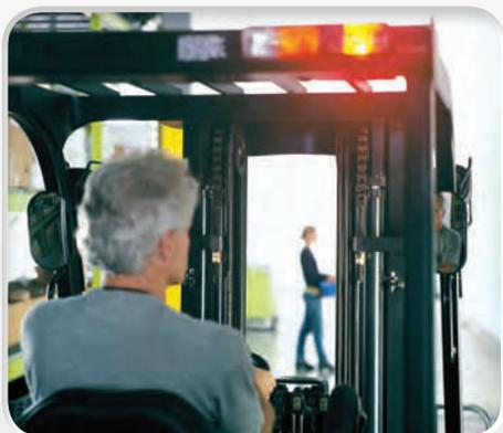
Profils I et U imbriqués avec galets inclinés permettent une **large visibilité** Et une **rigidité** du mât incomparable.
