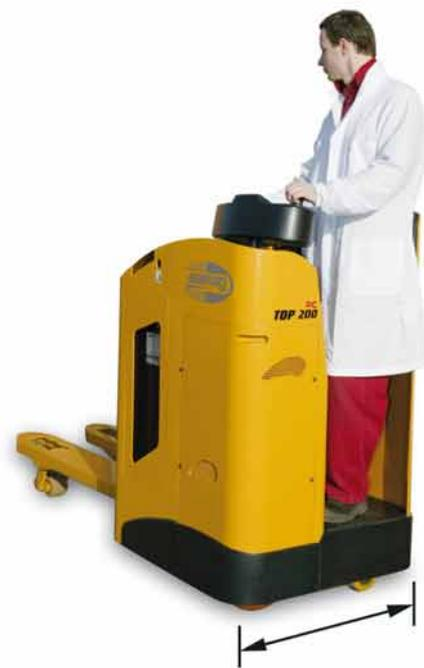
largeur châssis 770 mm
