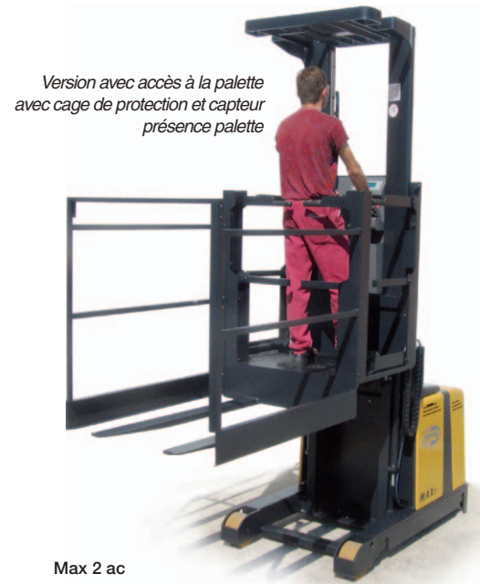
Commandes traction/soulèvement côté fourches (sur demande)
